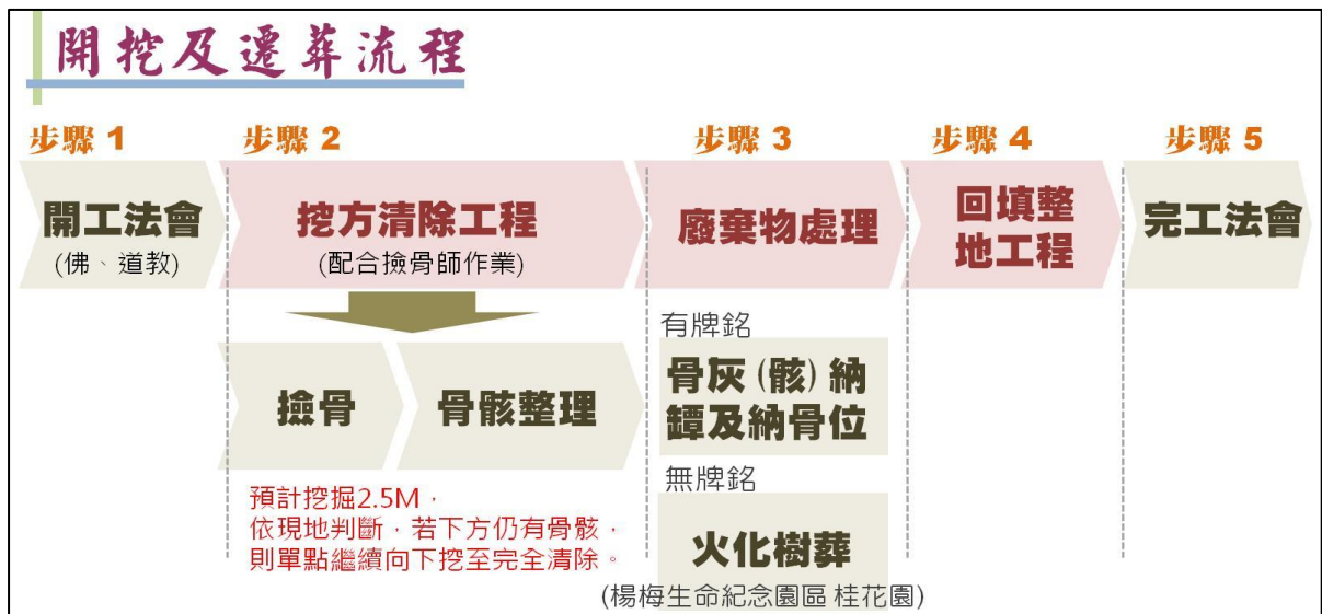
圖一、整地工程(開挖及遷葬)流程
