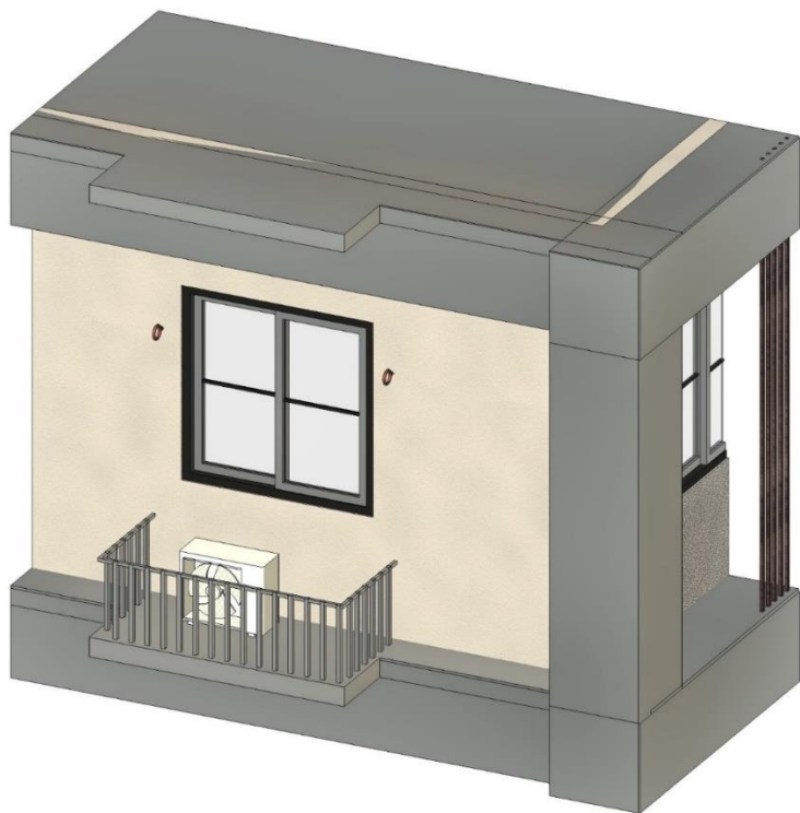
圖 2-1、雨遮設置室外機範例
