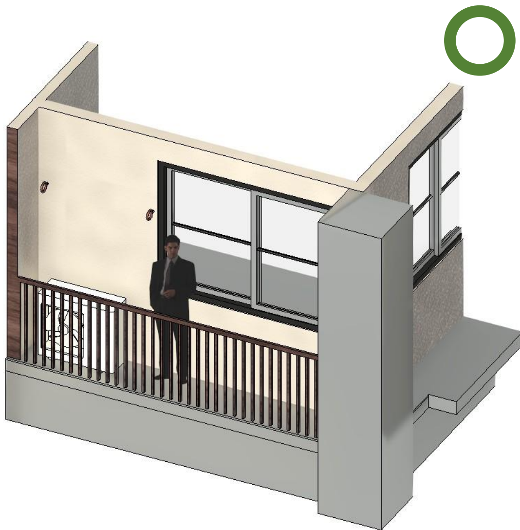
圖 2-2、露樑設置室外機範例
